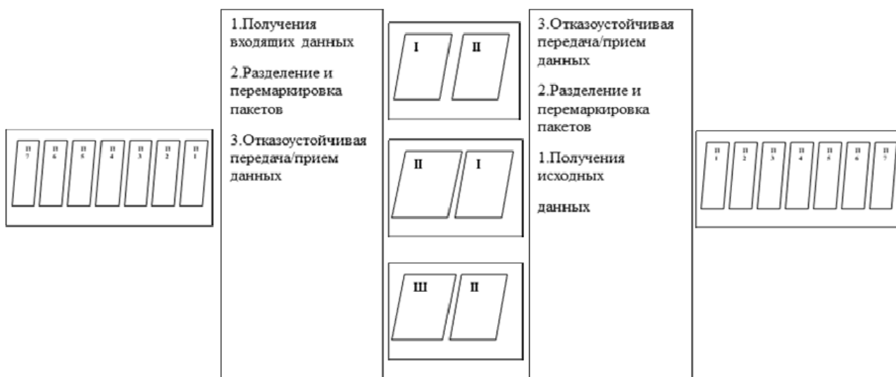
Рис. 2. Пример работы протокола гарантированной доставки в многомаршрутной среде
