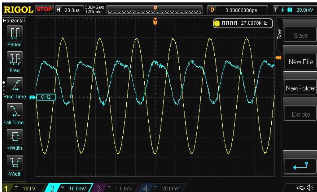
Рис. 4. Осциллограмма, отображающая зависимость напряжения на пьезоэлектрических преобразователях (желтая кривая) и напряжения на выходе фотодетектора от времени (голубая кривая)
